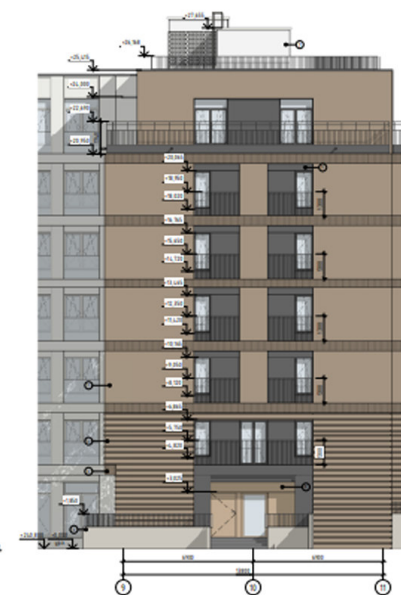
Секция 3. Корпус В. Фасад в осях 9-11
